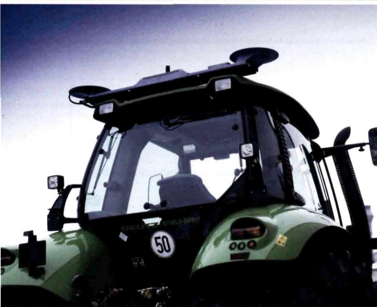
Il sistema Agrosky ASG può essere adattato anche ad altri trattori. I concessionari DEUTZ-FAHR dispongono di un kit standard di installazione che prevede l'antenna GPS, le valvole e i sensori di controllo dello sterzo, il terminale di controllo con touchscreen e il computer di bordo.
