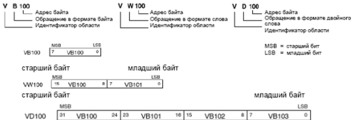
Рисунок 27 - Пример обращения к одному и тому же адресу в формате байта, слова и двойного слова
