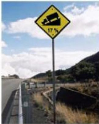
Rambu pada gambar disamping menandakan jalan di depan mempunyai kemiringan 17%. Hal ini berarti untuk setiap perubahan mendatar sejauh 100 m, terdapat perubahan secara vertikal 17 m. Dari gambar di samping, kita dapat menyatakan pergerakan kendaraan. Misalkan kemiringan jalan dari titik A ke titik B. Titik A dan B berkoordinat (0,0) dan (100, 17).
