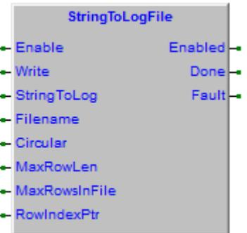
Questo è un blocco funzione protetto. Per utilizzarlo occorre richiedere il codice di protezione, vedi [protezione funzioni e blocchi funzione](#). E' comunque possibile utilizzarlo liberamente in modo test per 30 Min.
