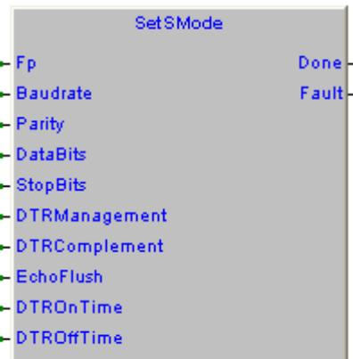
In caso di errore esecuzione (Esempio definizione di un parametro fuori range) il valore di impostazione della porta seriale non viene modificato e si attiverà l'uscita **Fault**.
