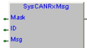
La funzione ricerca nello stack dei messaggi un messaggio il cui ID posto in AND con **Mask** coincide con **ID** messo in AND con **Mask**. La funzione ritorna TRUE se messaggio ricevuto.
