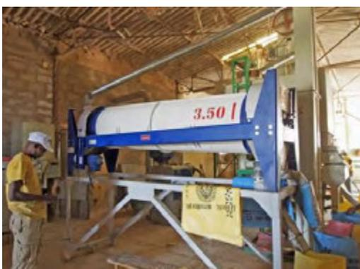
Calibreur installé dans une rizerie ; Il y fonctionne de concert avec le tamis rotatif.
