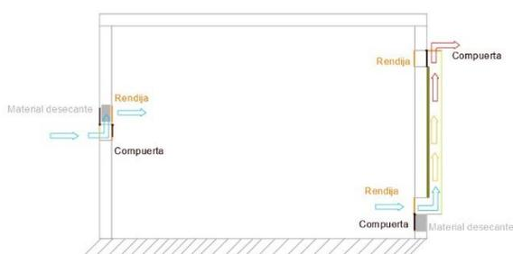
**Figura 7** Proceso de enfriamiento con deshumidificación
