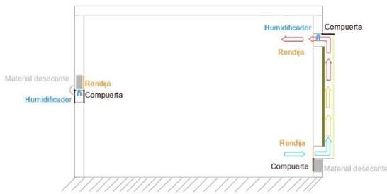
**Figura 4** Proceso de calentamiento con humidificación
