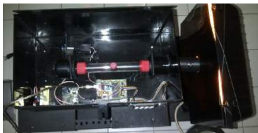
Gambar 2. Sistem instrumentasi polarimeter sebagai alat ukur larutan optik aktif
