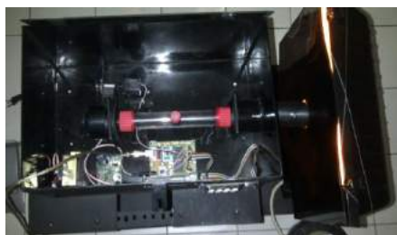
Gambar 4. Rancang Bangun Sistem instrumentasi Alat Ukur Konsentrasi Gula Terlarut
