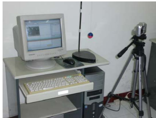
Gambar 4. Perangkat VBL untuk eksperimen getaran
