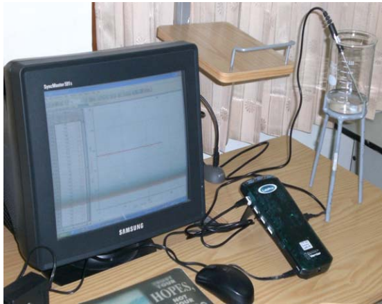
Gambar 5. Perangkat MBL untuk eksperimen Hukum Pendinginan Newton
