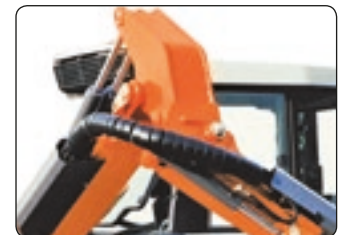
Meccanismo mobile a parallelogramma BMS (brevettato) SAB system Roll-over protective kit with inclinometer.
