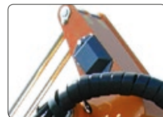
Antiribaltamento elettrico (SAB). Electric Roll-over protection system (SAB).
