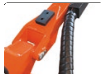
Sezione rettangolare del 1° braccio (mm 120x180). Rectangular section of 1st arm (mm 120x180).
