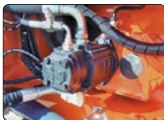
Pompa e motore ad ingranaggi ad alta potenza. High power gear pump and gear motors.
