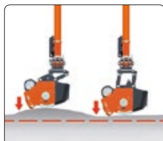
Dispositivo autolivellante. Self-levelling device.
