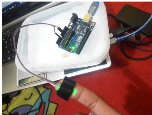
Gambar 6.8 Pengujian sensor heart rate pada ujung jari
