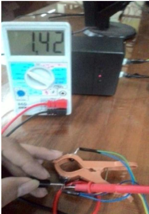
Gambar 8.17 Pengukuran V_{out} pada sensor photodiode
