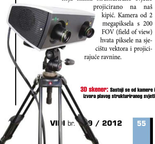
**3D skener:** Sastoji se od kamere i izvora plavog strukturiranog svjetla
