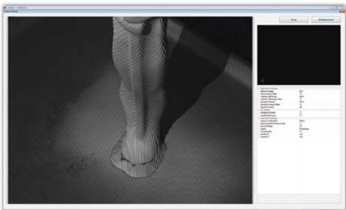
1. Kip se rotira na rotacijskom stolu, a na priključenom PC-ju pokrenuto je inicijalno snimanje u Comet Plus aplikaciji.
