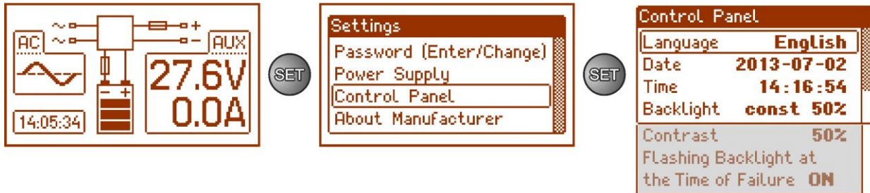
Fig. 23. „Control panel” screen.
