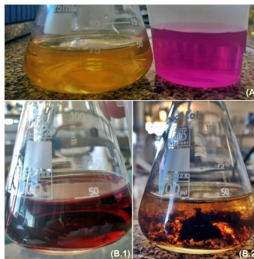
Figura 5. (A) Teste com solução 0,001M de K_2MnO_4 . (B.1) Teste com solução 0,002M de K_2MnO_4 antes da adição de H_2SO_4 . (B.2) solução 0,002M de K_2MnO_4 após a adição de H_2SO_4 .
