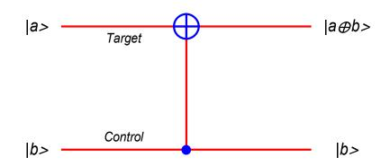
**Fig.5** CNOT gate:  $|b\rangle$ : control.  $|a\rangle$ : target.
