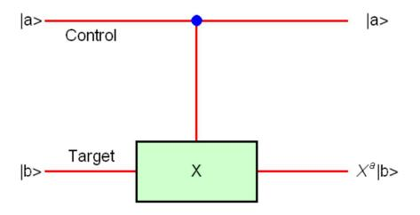
**Fig.3** Controlled X-gate.  $|a\rangle$ : control.  $|b\rangle$ : target.  $X^a |b\rangle$ .
