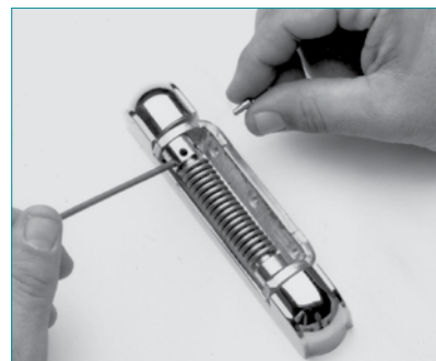
3. Ajuste la tensión; luego inserte el pasador de tope en el orificio del conjunto del buje de ajuste.
