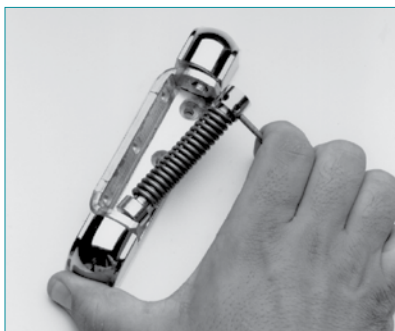
2. Coloque la arandela de presión y el buje sobre el pasador hexagonal en la bisagra montada. Inserte el pasador de ajuste en el conjunto del buje de ajuste. Sujetando el pasador de ajuste, comprima el resorte y coloque el conjunto del buje de ajuste sobre el pasador redondeado.
