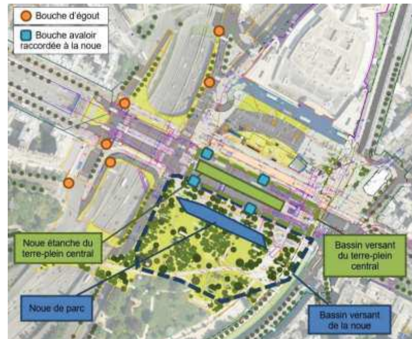
Figure 36 : Schéma de principe de gestion des eaux pluviales - source : Empreinte/paysage - Sathy/Architecte Urbaniste - IGREC ingénierie/BET VRD, 2019
