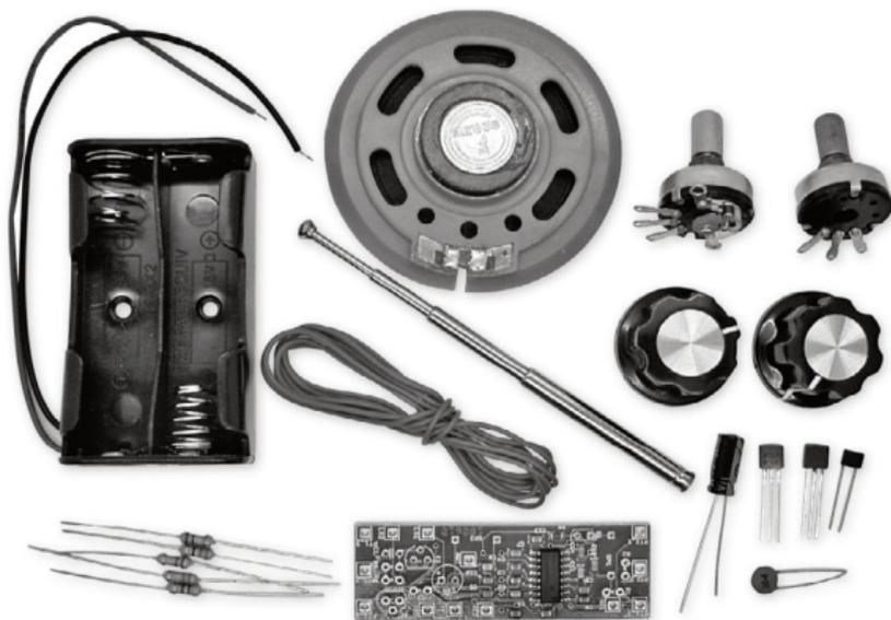
Platine pré-équipée à antenne étirable TDA7088
