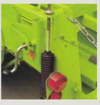
La densité se règle en continu à l'aide de deux manivelles situées à l'extrémité du canal de compression.
