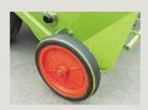
La roue de jauge du pick-up assure une adaptation parfaite au profil du sol.
