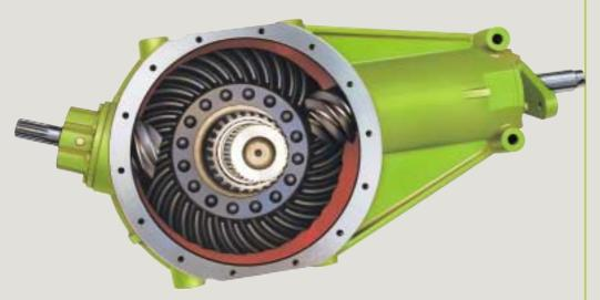
Le boîtier principal de la MARKANT est un engrenage hypoïde, c'est-à-dire que la couronne et les pignons coniques s'engrènent de façon hélicoïdale. Le nombre de dents qui sont en prise est de ce fait toujours supérieur à celui d'un engrenage droit, ce qui garantit une transmission plus sûre.
