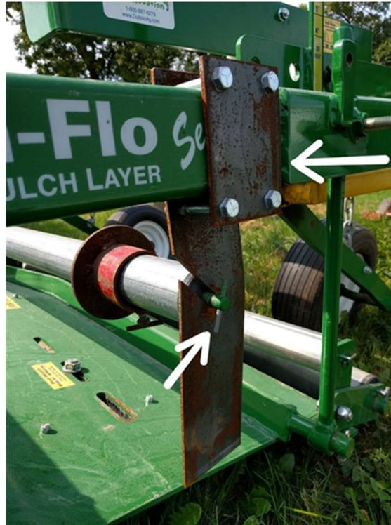
Figure 1. Modifications nécessaires pour optimiser la pose du paillis de papier. Elles consistent principalement à abaisser les supports pour le rouleau de papier.
