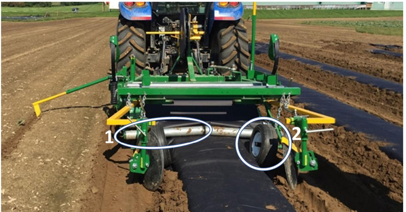
Figure 2. Identification des pièces causant les tensions lors de l'installation. #1 Rouleau de pression #2 Roue plumbeuse.
