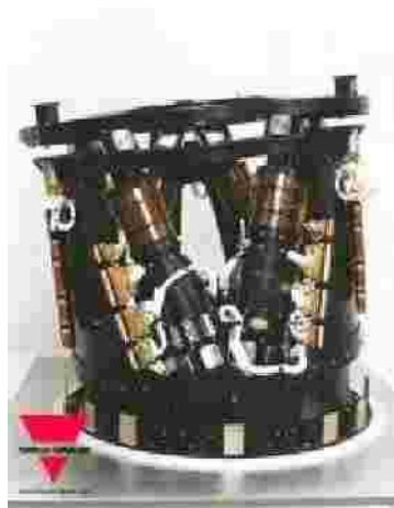
Il puntatore Hexapod con heaters sull'attuatore lineare
