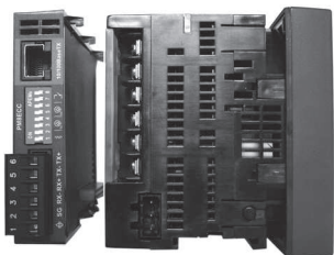
Multimetar PM870 sa ECC modulom (pogled sa donje strane konektori i konfiguracione preklopnicij).
