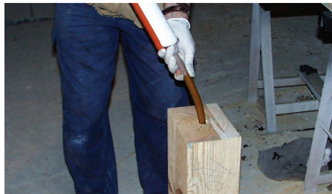
Preparação dos provetes para realização de ensaios de arrancamento de varões
