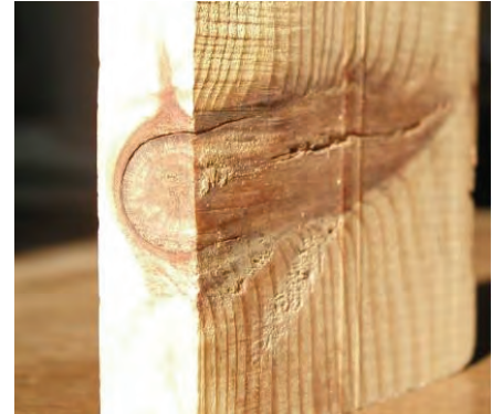
Os nós correspondem a fibras perpendiculares ao eixo da peça de madeira
