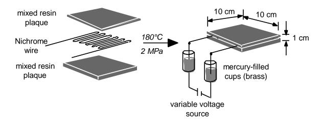
FIGURE 1. SMOLDERING SPECIMEN FABRICATION
