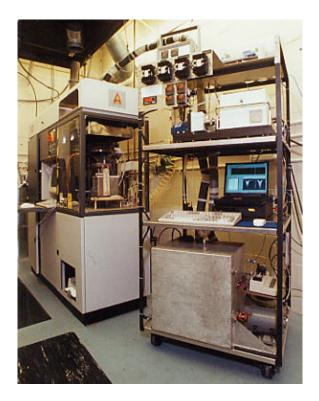
FIGURE 3. FTIR SAMPLING SYSTEM ALONGSIDE THE CONE CALORIMETER
