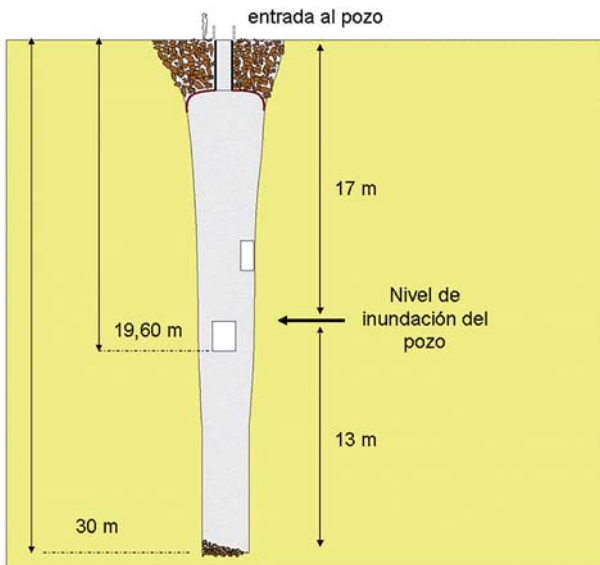
Fig. 12. Corte longitudinal del pozo El Salamanca Chico. / Section of El Salamanca Chico mine shaft.
