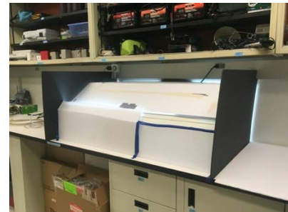
Incubateur construit pour avoir des conditions stables et adéquates (Température, UV, cycle d'exposition aux rayons UV...)
