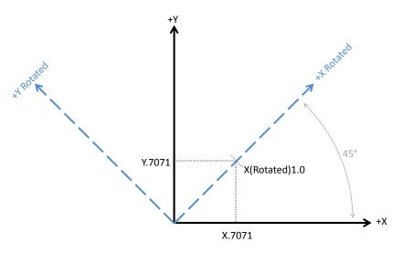
FIGURE 14 COORDINATE SYSTEM ROTATION (G68 X0 T0 R45)
