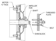
Fig. 5 Impeller Puller
