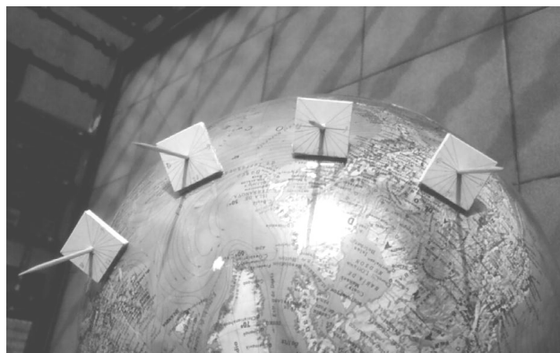
Fig. 12 Comprobación del funcionamiento de los relojes ecuatoriales en el globo terráqueo
