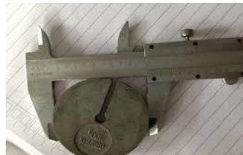
Gambar (b) Mengukur diameter luar logam menggunakan jangka sorong..
