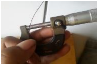
Gambar (a) Sebuah mikrometer yang digunakan untuk mengukur ketebalan kawat.
