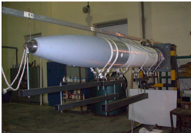
Figura 2. Ensayos Estáticos de la Carga Útil
