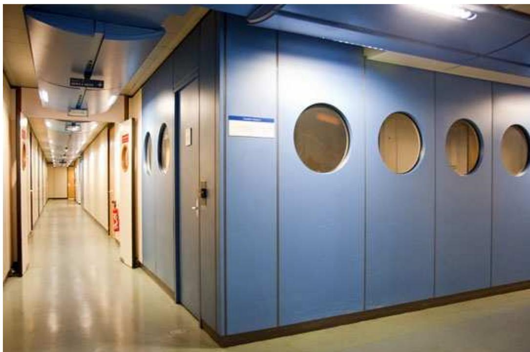
Les architectes ont anticipé les évolutions technologiques et structurelles possibles dès la construction du site. Avec ses 206 000 m<sup>2</sup> de surface de bureaux et 42 km de couloirs, il est entièrement pré-câblé et équipé de cloisons amovibles, il se montre toujours aussi fonctionnel aujourd'hui. © Cécile Debise/Journal du Net
