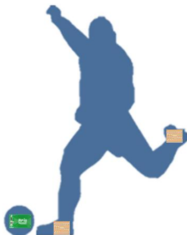
Figura 15 - Exemplo de leitor na bola e marca na sapatilha
