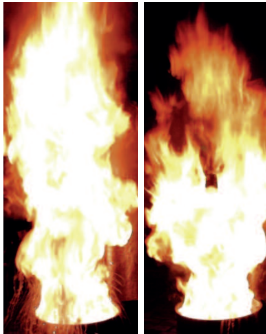
Bild 4: Vergleich der Flammbildung zwischen dem Vorgängerprodukt (links) und THERMISOL QH 35 MC (rechts) während der Versuchsreihe
