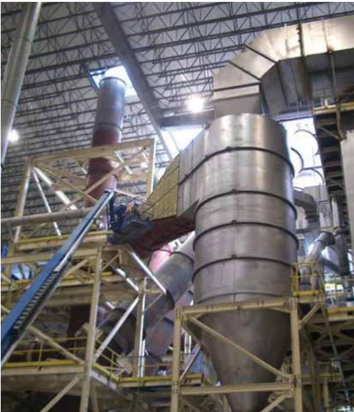
Las aplicaciones más comunes incluyen tanques de almacenamiento, hornos y equipo de secado, así como equipo petroquímico y de generación de energía. Con un punto de fusión de 1177 °C (2150 °F) y una temperatura de operación de 650 °C (1200 °F), RHT de Roxul fácilmente cumple con los requisitos de desempeño en superficies calientes. Además, RHT de Roxul es resistente al fuego, repelente al agua, y tiene estabilidad dimensional.
