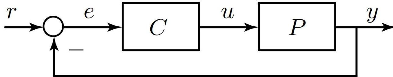
$$\frac{d}{dt} \begin{bmatrix} x(t) \\ z(t) \end{bmatrix} = \begin{bmatrix} A & b \cdot h \\ -g \cdot c & F \end{bmatrix} \cdot \begin{bmatrix} x(t) \\ z(t) \end{bmatrix} + \begin{bmatrix} 0 \\ g \end{bmatrix} \cdot r(t)$$
