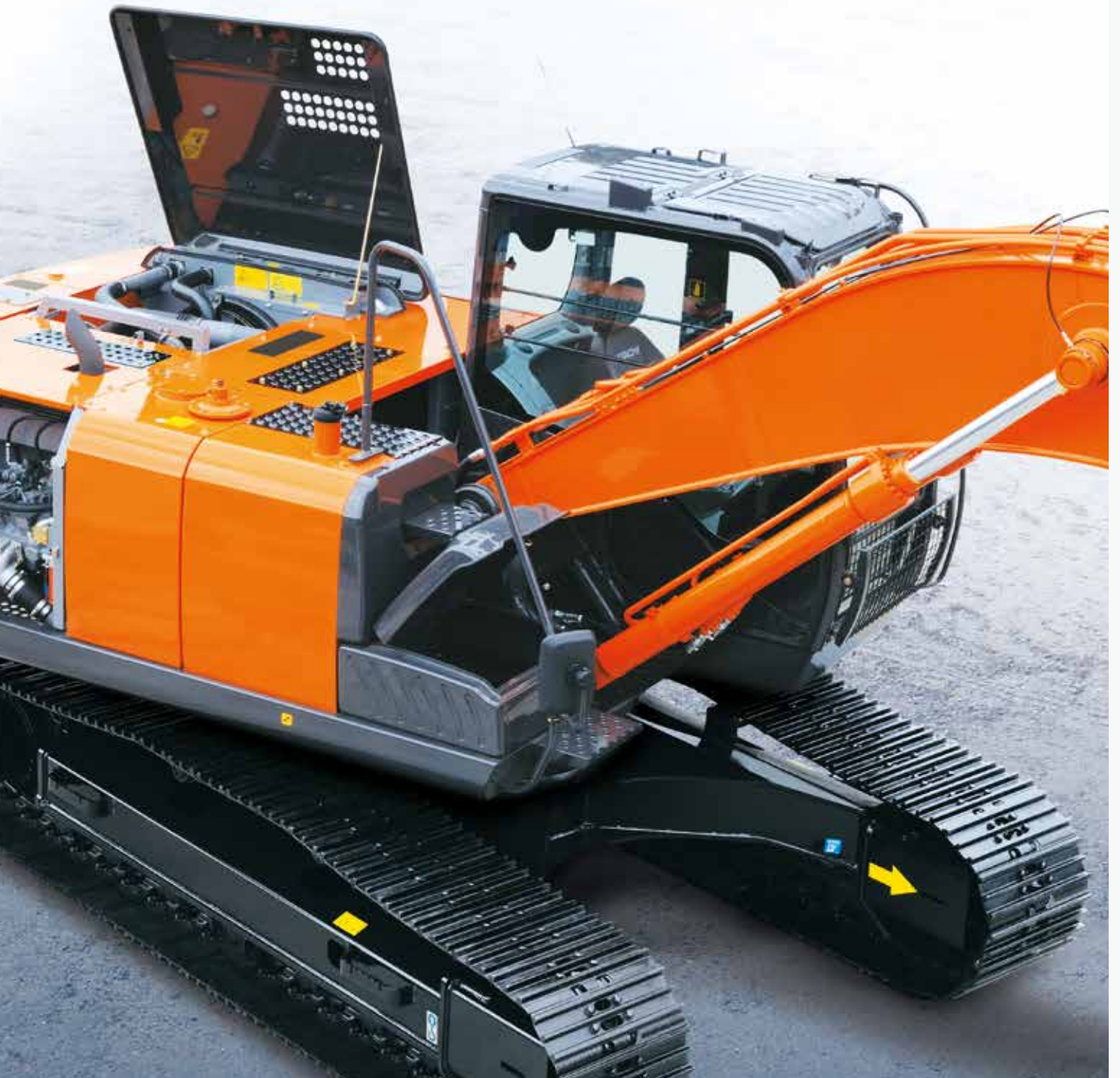
La photo montre une pelle hydraulique munie d'une protection inférieure de pare-brise en option.
