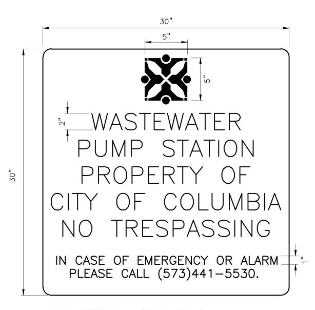
BLOCK LETTERS ON WHITE BACKGROUND SIGN PANEL SHALL BE STANDARD GAUGE ALUMINUM SHEETS SIGN SHALL BE FIELD LOCATED
