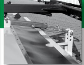
Knickgelenk zum Öffnen und Schließen der Sammelwanne
