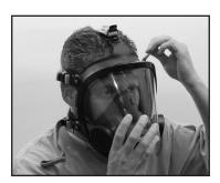
FIGURE 13J RETIGHTEN IF REQUIRED
