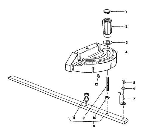
FIGURE 4 - 62694 MITER GAUGE ASSEMBLY
