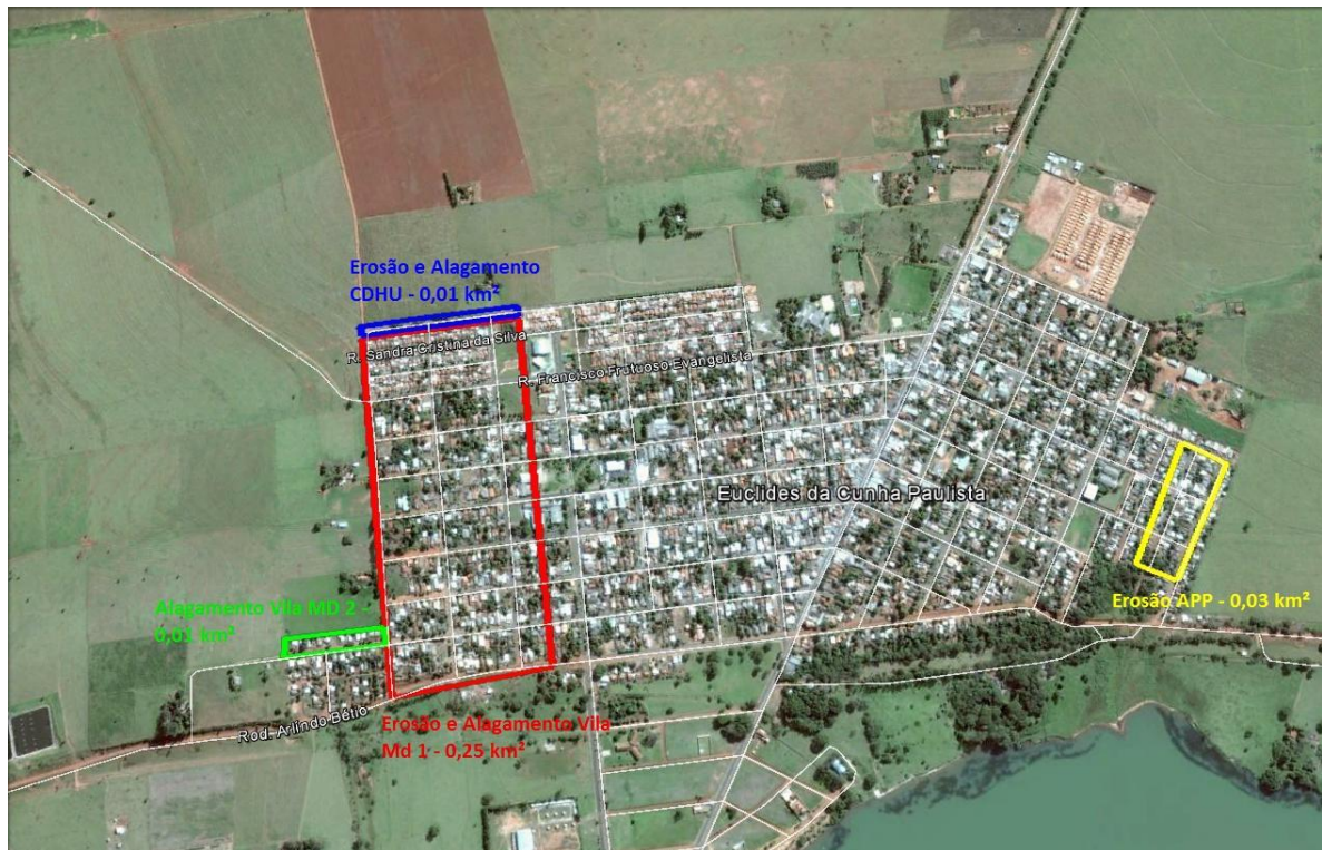
Figura 4.1 – Pontos críticos do sistema de microdrenagem
