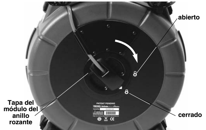
Figura 8 – Cierre de la tapa del módulo del anillo rozante
