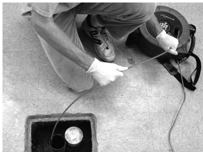
Figura 25 – Si la lazada del cable -entre el acceso al desagüe y el microReel- es excesiva, puede dañarse el cable
