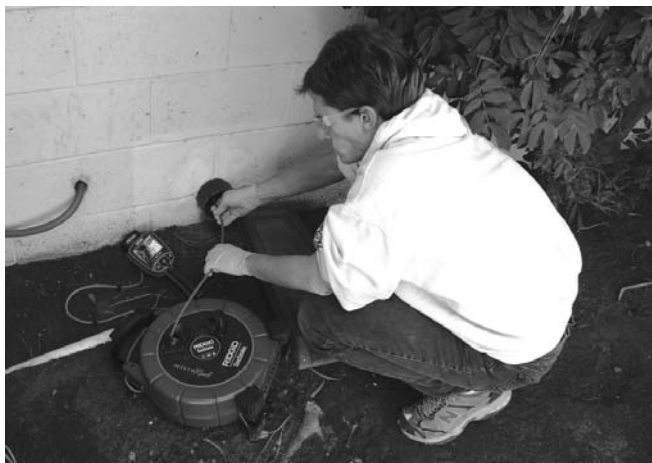
Figura 17 – Empleo del microReel
