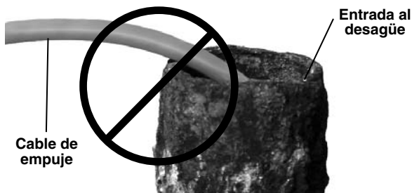
Figura 19 – Evite dañar el cable en bordes afilados
