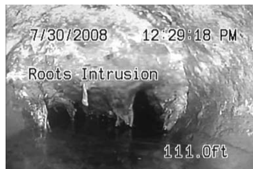
Figure 21 – Écran indiquant l'annotation sur diapo, l'heure et la distance parcourue (distance parcourue depuis le point zéro du système).
