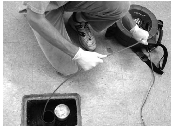
Figure 25 – Un câble bouclé risque de se plisser lors de son rembobinage
