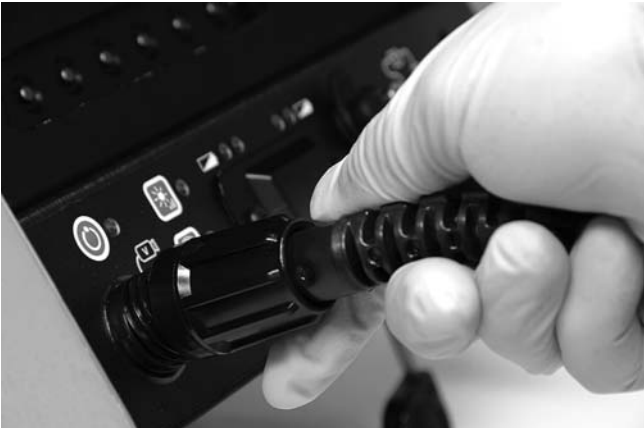
Figure 13 – Branchement sur CCU SeeSnake
