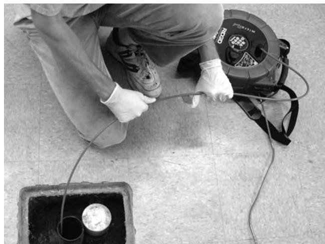
Figura 24 – Método apropiado para devolver el cable al tambor
