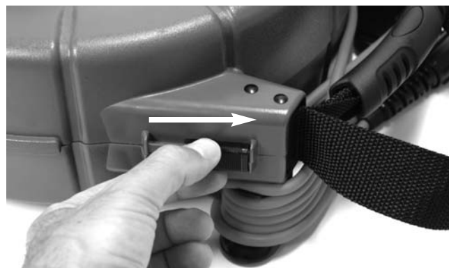
Figure 4 – Ouverture des loquets de l'enrouleur microReel
