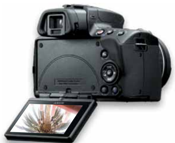
Ein schwenkbarer Monitor wie hier bei der Alpha 55 von Sony ist ungemein praktisch, wenn Sie aus ungewöhnlichen Perspektiven fotografieren. Selbst hoch über den Kopf und knapp über den Boden gehalten, können Sie damit den Bildausschnitt noch ganz exakt und gezielt wählen ( www.sony.de ).
