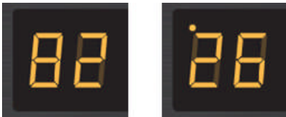
Das 7-Segment-Display zeigt 82 (links) und 126 (rechts) an.
