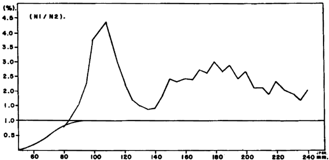
FIG.16 SELECTIVIDAD Y EFICIENCIA DE CAPTURA DE LA RED TIPO SEMIPORTUGUESA.(METODO DE LANCES ALTERNADOS).
