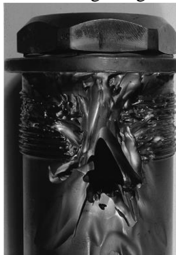
Gambar 2.1 Komponen wellhead yang tererosi (Byars, 1999)
