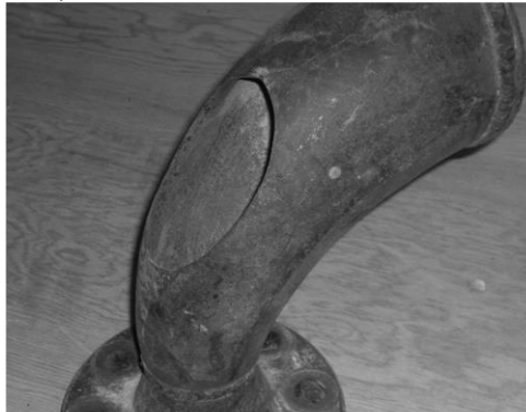
Gambar 1.1 Korosi Erosi pada Pipa Elbow Gas Alam (Heidersbach, 2011)
