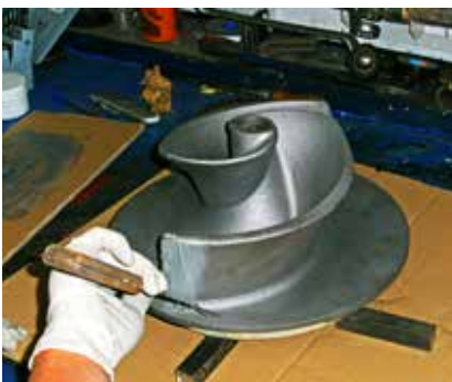
Reconstrucción de impulsor con DEVCON Pasta Titanio.
