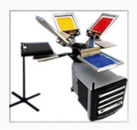
Também conhecido como Silk screen, é um sistema que consiste numa tela de tecido muito fino esticado de material bastante resistente, o suficiente Para ser esticada e presa em um quadro com sua tensão máxima, sobre esta tela a imagem é gravada de maneira semelhante ao processo Offset.
