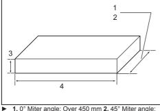
1. 0° Miter angle: Over 450 mm 2. 45° Miter angle: Over 325 mm 3. 38 mm 4. Over 760 mm
