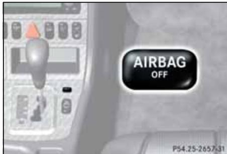
Das Sensorsystem für den Beifahrersitz erkennt automatisch, ob dort ein spezieller Mercedes-Benz Kindersitz mit Transponder montiert wurde. In diesem Fall leuchtet in der Mittelkonsole die Kontrollleuchte
