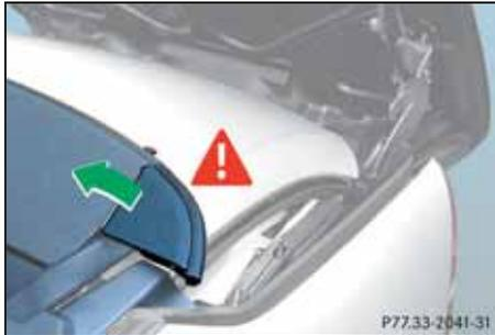
! Klappen Sie die Seitenklappen der Abdeckung nicht mit der Hand hoch. Sie können sonst die Dachmechanik beschädigen.
